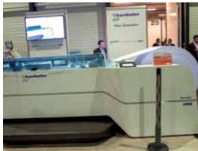
De nieuwe Hunkeler POPP8 Unwinder haalt een topsnelheid van 305 meter per minuut.
